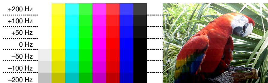
Obrázek 3.10.: Barevné zkreslení RGB při nesprávném naladění protistanice.
