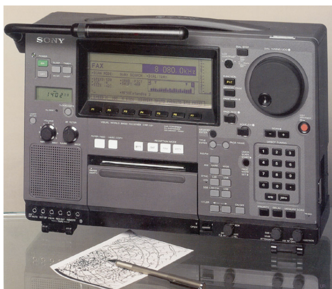
Obrázek 11.4.: Moderní přijímač Sony CRF-V21 pro příjem FAX a RTTY vybavený tiskárnou.
